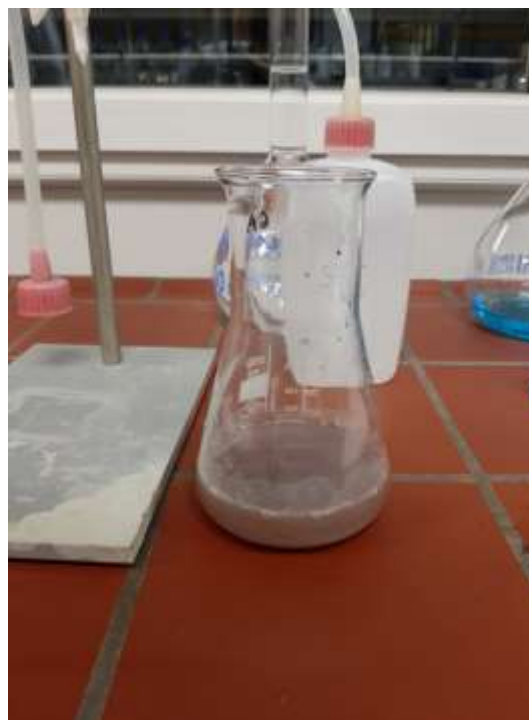
Slika 8: Barva zmesi v erlenmajerici po končani titraciji z \text{Na}_2\text{S}_2\text{O}_3 (Sedmak, 2019)
