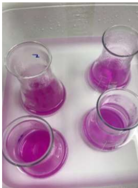
Slika 10: Barva zmesi v erlenmajerici po končani titraciji z NaOH (Zorenč, 2019)
